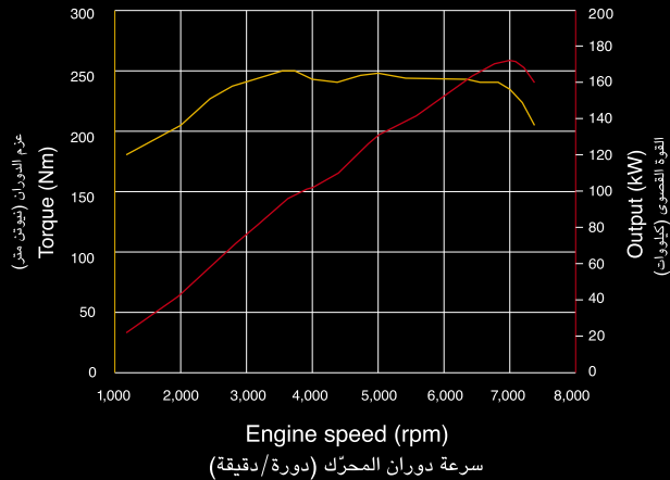
محرك بأربع اسطوانات متقابلة أفقيًا منحنى أداء المحرك Horizontally Opposed 4-cylinders Engine Engine Performance Curve
