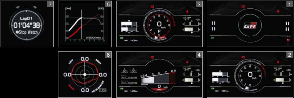
عداد BOXER (مقاس 7 بوصات ملون TFT + عداد بشاشة عرض LCD). 1. الشاشة المبدئية. 2. الوضع العادي NORMAL. 3. الوضع الرياضي SPORT. 4. وضع المضمار TRACK. 5. منحنى القدرة وعزم الدوران. 6. شاشة عرض G. 7. ساعة إيقاف BOXER METER (7-inch TFT color + LCD display meter) 1. Opening 2. NORMAL mode 3. SPORT mode 4. TRACK mode 5. Power & Torque curve 6. G monitor 7. Stop Watch
