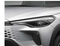
إضاءة أمامي من نوع LED ثنائي الشعاع Bi-Beam LED Headlamp
