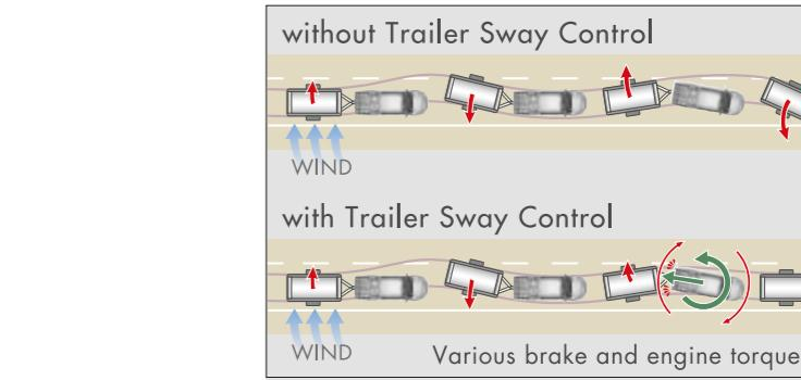
**التحكم في تمايل المقطورة:** عند قطع مقطورة، يرصد النظام أي تمايل في المقطورة ويساعد على كبحه عن طريق خفض قدرة المحرك في الفرملة وقدرة خرج المحرك.
