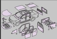
**ألواح صلب مقاومة للصدأ:** يسهم الاستخدام المكثف لألواح الصلب المضادة للصدأ ككسوة لهيكل السيارة وسطحها فعزيادة متانتها وقوتها، مهما كانت الظروف قاسية.
