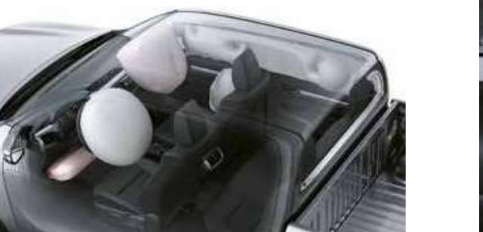
**أكياس الهواء:** سيارة هيلوكس مجهزة بكيس هوائي للسائق وكيس هوائي SRS للراكب الأمامي وكيس هوائي SRS للركبتين (مقدع السائق) وكيس هوائي SRS جانبي ISOFIX (للمقاعد الأمامية) وأكياس الدرع الستائرية (SRS) (للمقاعد الأمامية والخلفية).\*
